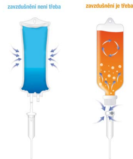
Obrázek 1. Schématické znázornění funkce uzavřeného a otevřeného infuzního systému
